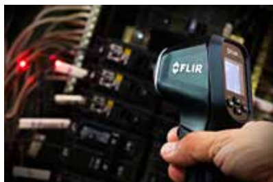
Eenvoudige identificatie van meetlocatie met ingebouwde laser
