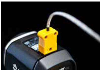
TG56 voorzien van aansluiting voor thermokoppel type K
